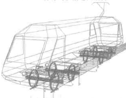
图2 2B 0 架悬机车的物理模型
