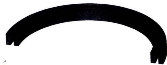
图 3 径向迷宫密封三维网格模型
