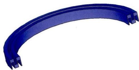
图 1 径向迷宫密封 1/2 结构模型
